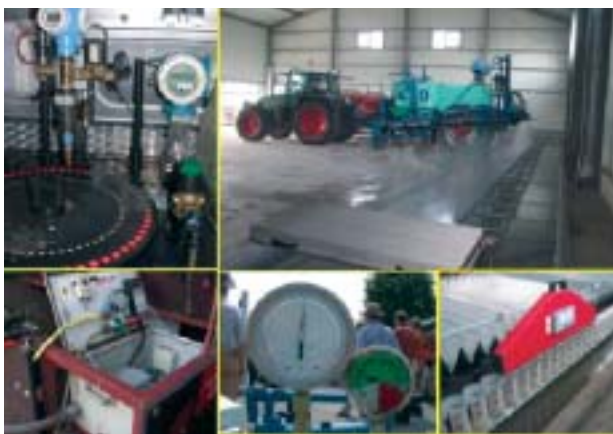
Διατάξεις δοκιμών για τη μέτρηση παροχής ακροφυσίων κατανομής ψεκαστικού υγρού και αποδόσεων αντλίας.
