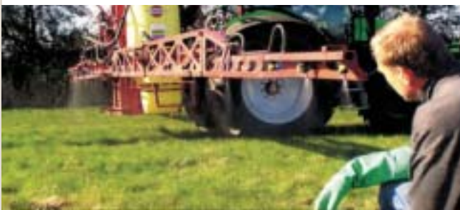
Οπτικός έλεγχος λειτουργίας και κατανομής ακροφυσίων.
