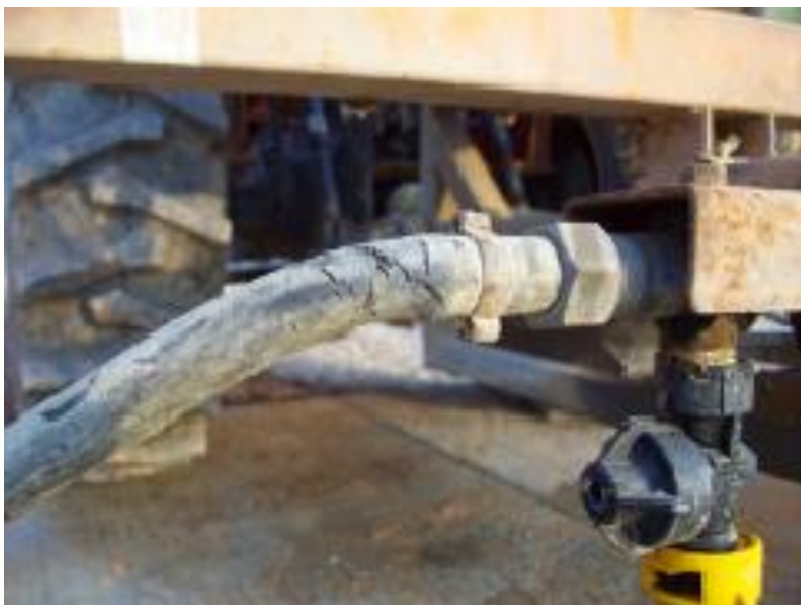
Σωλήνας σε κακή κατάσταση
